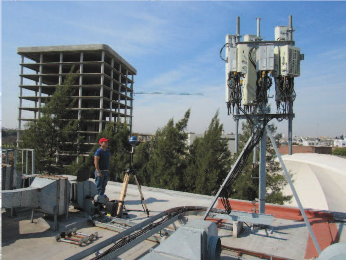
Medición RNI en el emplazamiento sector B
