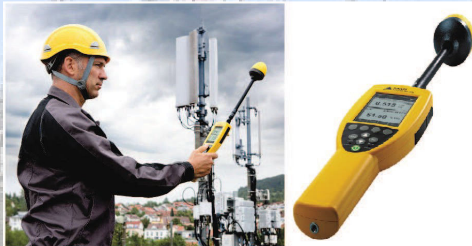
Narda NBM-550: Bandwidth 300kHz - 50 GHz, sondas intercambiables, incluye GPS
