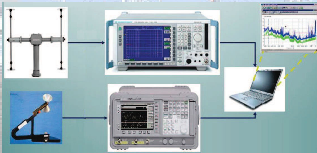
Instrumental: antenas directivas + analizador de espectro + PC
